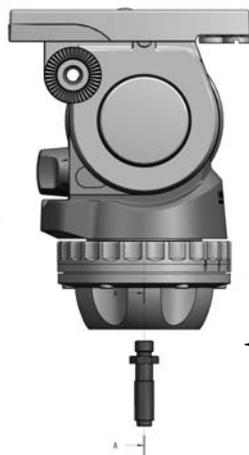
Um den FSB 6 mit Flachbodenanschluss verwenden zu können, muß der Gewindezapfen entfernt werden.
